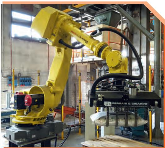
**Robot palletizzatore per sacchi**
