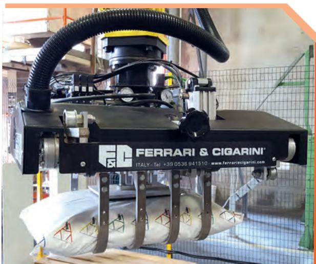
**Robot palletizzatore per sacchi**
