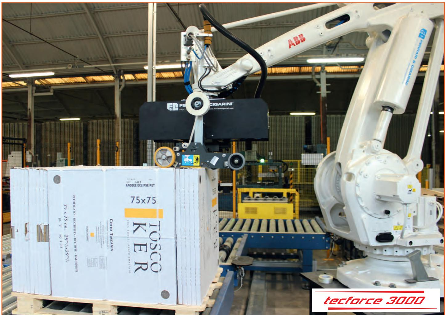
Robot palletizzatore con nastratrice
