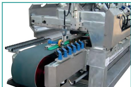
Guida appoggio materiale automatica e pressore pneumatico
